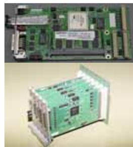
3Uユーロ基板7枚でCCD64個を10秒で読み出し
